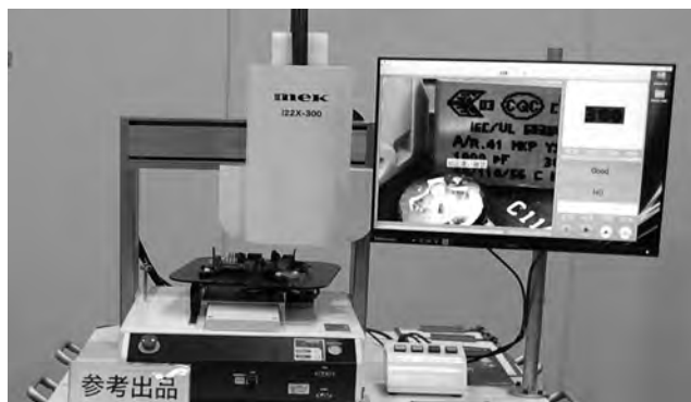
写真10 卓上型多機能検査装置『i22X-300』
