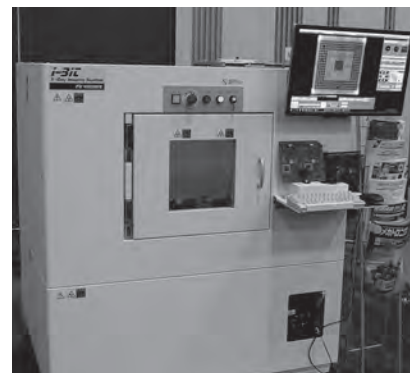
写真3 3D-X線ステレオ方式X線検査装置『FX-400tRX』
